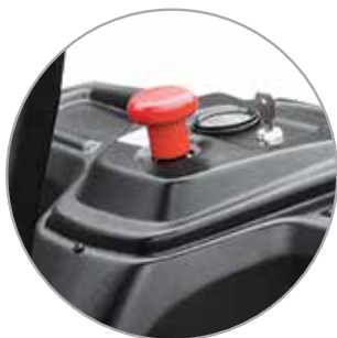
Кнопка аварийного отключения Легко отключается оператором в случае экстренной необходимости
