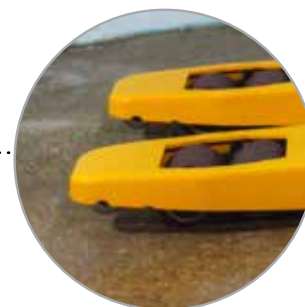
Вилы с напылением и дополнительным роликом Предотвращает порчу паллет
