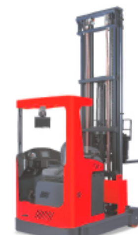
Рич трак Модель: R1.5/R1.6/R2.0/R2.0HD Грузоподъемность (кг): 1500/1600/2000/2000 Высота подъема (м): 3-8/9.5/3-7.4/8-12
