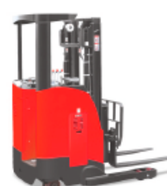
Рич трак с выдвижными вилами Модель: RRF1.5/RRF1.8/RRF2.0 Грузоподъемность (кг): 1500/1800/2000 Высота подъема (м): 3-9
