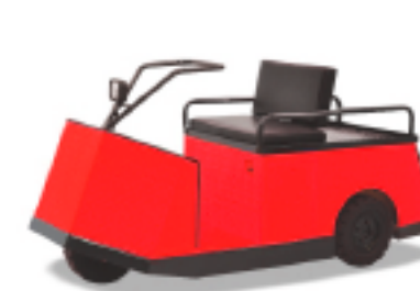
Тягач электрический Модель: T00.5 Грузоподъемность (кг): 500
