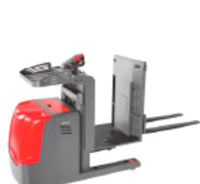
Подборщик заказов нижнего уровня Модель: LO1.0LT Грузоподъемность (кг): 1000 Высота подъема (м): 1-1.2
