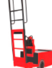
Тягач электрический Модель: TS2.2 Грузоподъемность (кг): 2200
