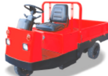
Тягач электрический Модель: TRC1.0/TRC1.5 Грузоподъемность (кг): 1000/1500
