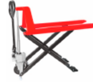
Ручная гидравлическая тележка с подъемом вил Модель: HPL1.0 Грузоподъемность (кг): 1000 Высота подъема (м): 0.8
